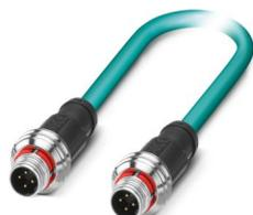
Cavo di rete, Ethernet CAT5 (100 MBit/s), 4-poli, PUR senza alogenati, azzurro mare RAL 5021, schermata (Advanced Shielding Technology), Maschio diritto M12 Push-Pull, codifica: D / IP67, su Maschio diritto M12 Push-Pull, codifica: D / IP67, lunghezza cavo: 1 m
