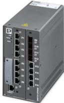
Switch Managed con 12 porte RJ45 con 10/100/1000 MBit/s, 4 porte SFP con 100/1000 MBit/s, temperatura di esercizio: -40 °C ... +85 °C, alimentatore: 100 V AC/DC ... 240 V AC/DC (valore nominale)
