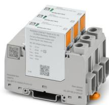
Scaricatore di sovratensione, secondo Tipo 2 / Class II, per sistemi fotovoltaici a tensione continua a 2 poli isolati e collegati a terra 1500 V DC, per montaggio su guida DIN, elemento base a 3 poli, tre elementi di protezione a innesto monitorati termicamente, segnalazione di stato su ogni connettore.
