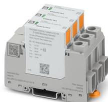
Scaricatore di sovratensione, secondo Tipo 2 / Class II, per sistemi fotovoltaici a tensione continua a 2 poli isolati e collegati a terra 1000 V DC, per montaggio su guida DIN, elemento base a 3 poli con contatto di segnalazione remota, tre elementi di protezione a innesto monitorati termicamente, segnalazione di stato su ogni connettore.
