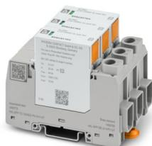
Scaricatore di sovratensione, secondo Tipo 2 / Class II, per sistemi fotovoltaici a tensione continua a 2 poli isolati e collegati a terra 1000 V DC, per montaggio su guida DIN, elemento base a 3 poli, tre elementi di protezione a innesto monitorati termicamente, segnalazione di stato su ogni connettore.
