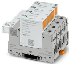
Scaricatore di sovratensioni ad innesto, secondo tipo 2/Classe II, per reti di alimentazione trifase con PE e N posati insieme in un conduttore (sistema a 4 conduttori: L1, L2, L3, PEN), con contatto FM.
