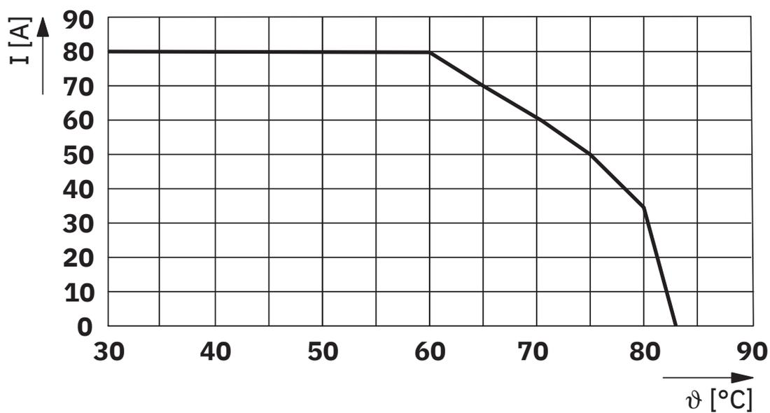
Corrente max. ammissibile in funzione della temperatura ambiente
