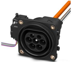
CHARX connect universal, AC tipo 2, Presa di ricarica del veicolo, 32 A , 250 V AC, Fili singoli, lunghezza: 2 m, attuatore di bloccaggio: 12 V, 4 poli, Montaggio sulla parete anteriore e posteriore, M6, custodia: nero, per la ricarica con corrente alternata (AC) di veicoli elettrici (EV), IEC 62196-2, La fornitura comprende un cappuccio di protezione per i contatti AC.
