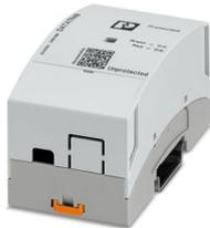
Protezione contro la sovratensione con indicatore di stato per interfacce di telecomunicazione analogiche e digitali (VDSL fino a 250 MBit/s, G.fast fino a 1,5 GBit/s) in custodia a parete). In alternativa inseribile a scatto su guida DIN. Protezione da sovraccarico integrata (Power-cross). Connessione: RJ45 (RJ12) e Push-in.
