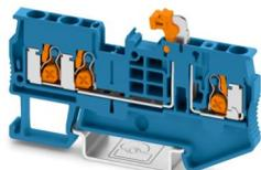
Morsetto con sezionatore a coltello, tensione nominale: 500 V, corrente nominale: 20 A, tipo di connessione: Connessione Push-X, Sezione di dimensionamento: 2,5 mm<sup>2</sup>, sezione: 0,5 mm<sup>2</sup> - 4 mm<sup>2</sup>, montaggio: NS 35/7,5, NS 35/15, colore: blu
