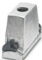
Custodia mobile HEAVYCON ADVANCE B24, con bloccaggio a baionetta (esagono cavo) in acciaio inox, alluminio impermeabile, altezza 100 mm, con filettatura 1x M32, uscita cavo diritta, senza superficie; guarnizione conduttiva (caratteristiche EMC)
