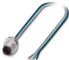
Connettore per apparecchi anteriore, 3-poli, Connettore, diritto, M12-SPEEDCON, codifica: A, su estremità conduttore libera, Montaggio anteriore, M16 x 1,5, Fili singoli, lunghezza cavo: 0,5 m, 0,34 mm<sup>2</sup>, Filo in TPE, saldato, Questo articolo è in continuo adattamento. Alternativa senza piombo secondo RoHS II senza eccezione 6c (Pb < 0,1%) possibile in anticipo su richiesta.
