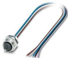
Connettore per apparecchi anteriore, Universale, 5-poli, Femmina, diritto, M12-Standard, codifica: A, su estremità conduttore libera, Montaggio anteriore, M16 x 1,5, Fili singoli, lunghezza cavo: 0,5 m, 0,34 mm<sup>2</sup>, Filo in TPE, saldato
