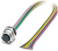
Connettore per apparecchi posteriore, Universale, 12-poli, Femmina, diritto, M12-Standard, codifica: A, su estremità conduttore libera, Montaggio posteriore, M16 x 1,5, Fili singoli, lunghezza cavo: 2 m, 0,14 mm<sup>2</sup>, Filo in TPE, saldato, Prodotto alternativo secondo RoHS II senza eccezione 6c (Pb < 0,1 %) cod. art.: 1239856
