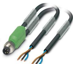
Cavo sensore/attuatore, 3-poli, PUR senza alogenati, grigio-nero RAL 7021, Maschio diritto M8, codifica: A, su estremità conduttore libera e estremità conduttore libera, lunghezza cavo: 3 m
