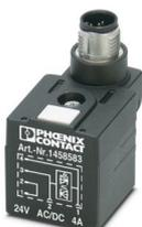
Connettore per valvole, 4-poli, Maschio diritto M12, codifica: A, su Connettore per valvole A (DESINA), con 1 LED, Circuito: Diodo Z
