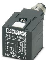
Connettore per valvole, 3-poli, Maschio angolato M12 SPEEDCON, codifica: A, su Connettore per valvole A, con 1 LED, Circuito: Diodo Z
