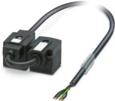
Cavo per doppio connettore per valvole, 4-poli, PUR/PVC, nero, estremità conduttore libera, su Connettore per valvole A, con 1 LED , Circuito: Diodo Z e Connettore per valvole A, con 1 LED , Circuito: Diodo Z, lunghezza cavo: 5 m, distanza connettori per valvole: 0,2 m
