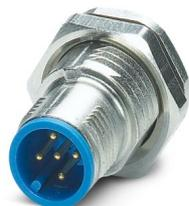
Connettore per apparecchi posteriore, 5-poli, Connettore, diritto, M12-SPEEDCON, codifica: A, Montaggio posteriore, M16 x 1,5, Codoli, Questo articolo è in continuo adattamento. Alternativa senza piombo secondo RoHS II senza eccezione 6c (Pb < 0,1%) possibile in anticipo su richiesta.
