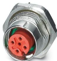
Connettore per apparecchi posteriore, 4-poli, Femmina, diritto, M12-SPEEDCON, codifica: A, Montaggio posteriore, M16 x 1,5, Codoli, Questo articolo è in continuo adattamento. Alternativa senza piombo secondo RoHS II senza eccezione 6c (Pb < 0,1%) possibile in anticipo su richiesta.
