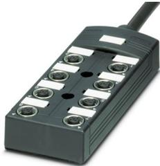
Scatola di distribuzione, applicazione: Esterni, tipo di connessione: Connettore femmina M12 Metallo, numero degli slot: 8, numero poli: 5, codifica: A, occupazione slot: doppi, segnalazione di stato: no, Universale; connessione linea principale: Attacco fisso 180°, PUR/PVC, lunghezza cavo: 10 m, schermatura: no
