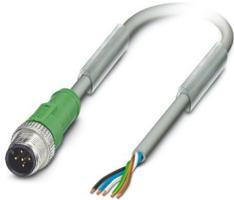
Cavo sensore/attuatore, 5-poli, PUR senza alogenati, resistente agli spruzzi di saldatura, altamente flessibile, grigio RAL 7001, Maschio diritto M12, codifica: A, su estremità conduttore libera, lunghezza cavo: 10 m, per robot e catene portacavi
