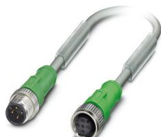
Cavo sensore/attuatore, 4-poli, PUR senza alogenati, resistente agli spruzzi di saldatura, altamente flessibile, grigio RAL 7001, Maschio diritto M12, codifica: A, su Connettore femmina diritto M12, codifica: A, lunghezza cavo: 3 m, per robot e catene portacavi
