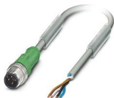
Cavo sensore/attuatore, 4-poli, PUR senza alogenati, resistente agli spruzzi di saldatura, altamente flessibile, grigio RAL 7001, Maschio diritto M12, codifica: A, su estremità conduttore libero, lunghezza cavo: 3 m, per robot e catene portacavi
