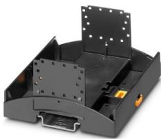
Custodia per guide DIN per l'impiego nei ripartitori di installazione a norma DIN 43880, Base custodia con piedino di fissaggio, larghezza: 107,6 mm, altezza: 89,7 mm, profondità: 48,9 mm, colore: nero (simili RAL 9005), collegamento trasversale: Connettore per guide di supporto (opzionale), n. poli connettore trasversale: 16
