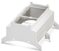
Custodia per guide DIN per l'impiego nei ripartitori di installazione a norma DIN 43880, Parte superiore custodia (U11) con feritoie di ventilazione, Profondità di incasso della tecnologia di connessione: 11,1 mm, larghezza: 107,6 mm, altezza: 89,7 mm, profondità: 54,85 mm, colore: grigio chiaro (simili RAL 7035)
