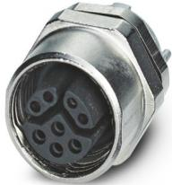
Connettore per apparecchi posteriore, Ethernet CAT5 (IEC 11801:2002), 8-poli, Femmina, diritto, M12-SPEEDCON, codifica: Y, Montaggio dei circuiti stampati, M12 x 1, Attacco a saldare THR, Questo articolo è in continuo adattamento. Alternativa senza piombo secondo RoHS II senza eccezione 6c (Pb < 0,1%) possibile in anticipo su richiesta.
