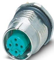
Connettore per apparecchi posteriore, Ethernet CAT5 (100 MBit/s), 4-poli, Femmina, diritto, M12-SPEEDCON, codifica: D, Montaggio posteriore, M16 x 1,5, Saldatura a onde, Questo articolo è in continuo adattamento. Alternativa senza piombo secondo RoHS II senza eccezione 6c (Pb < 0,1%) possibile in anticipo su richiesta.
