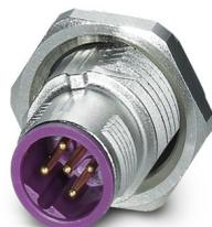
Connettore per apparecchi posteriore, 5-poli, Connettore, diritto, M12-SPEEDCON, codifica: B, Montaggio posteriore, Pg9, Codoli, Questo articolo è in continuo adattamento. Alternativa senza piombo secondo RoHS II senza eccezione 6c (Pb < 0,1%) possibile in anticipo su richiesta.
