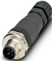
Connett. maschio sensore/attuato., diritto, 5 poli, M12, codifica A, conness. a vite, zigrinat. in metallo, conness. a vite per cavi Pg7 SKINTOP®
