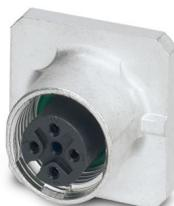
Connettore per apparecchi anteriore, Universale, 4-poli, Femmina, diritto, M12-SPEEDCON, codifica: A, Montaggio anteriore/flangia quadrata, Saldatura a onde, 0,34 mm<sup>2</sup>
