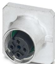
Connettore per apparecchi anteriore, Universale, 4-poli, Femmina, diritto, M12, codifica: D, Montaggio anteriore/flangia quadrata, Codoli, 0,34 mm<sup>2</sup>
