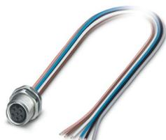
Connettore per apparecchi posteriore, 6-poli, Femmina, diritto, M8, codifica: A, su estremità conduttore libera, Montaggio posteriore, M10, Fili singoli, lunghezza cavo: 0,5 m, 0,14 mm<sup>2</sup>, filo in PVC
