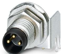
Connettore per apparecchi posteriore, 3-poli, Connettore, angolato, M8, Montaggio posteriore, M8 x 1, Saldatura a onde
