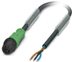
Cavo sensore/attuatore, 3-poli, PUR senza alogenati, grigio-nero RAL 7021, Maschio diretto M12, codifica: A, su estremità conduttore libera, lunghezza cavo: 1,5 m, con ghiera in plastica
