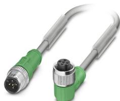
Cavo sensore/attuatore, 5-poli, PUR senza alogenati, resistente agli spruzzi di saldatura, altamente flessibile, grigio RAL 7001, Maschio diritto M12, codifica: A, su Connettore femmina angolato M12, codifica: A, lunghezza cavo: 0,6 m, per robot e catene portacavi
