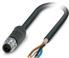
Cavo sensore/attuatore, 4-poli, PE-X/PE-X senza alogenati, grigio-nero RAL 7021, schermata, Maschio diritto M12, codifica: A, su estremità conduttore libera, lunghezza cavo: 10 m, per applicazioni outdoor, con zigrinatura in acciaio inox
