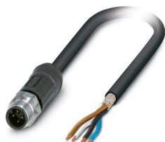
Cavo sensore/attuatore, 4-poli, PE-X/PE-X senza alogenati, grigio-nero RAL 7021, schermata, Maschio diritto M12, codifica: A, su estremità conduttore libera, lunghezza cavo: 2 m, per applicazioni outdoor , con zigrinatura in acciaio inox
