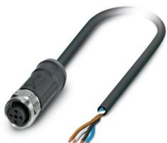
Cavo sensore/attuatore, 4-poli, PE-X senza alogenati, grigio-nero RAL 7021, estremità conduttore libera, su Connnettore femmina diritto M12, codifica: A, lunghezza cavo: 2 m, per applicazioni outdoor , con zigrinatura in acciaio inox
