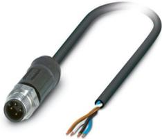
Cavo sensore/attuatore, 4-poli, PE-X senza alogenati, grigio-nero RAL 7021, Maschio diritto M12, codifica: A, su estremità conduttore libera, lunghezza cavo: 5 m, per applicazioni outdoor, con zigrinatura in acciaio inox
