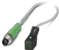
Cavo sensore/attuatore, 2-poli, PUR, grigio RAL 7001, Maschio diritto M8, su Connettore per valvole Festo ZC, con 1 LED, Circuito: Circuito di protezione e riduzione della corrente di mantenimento, lunghezza cavo: 0,3 m
