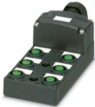
Scatola di distribuzione, applicazione: Standard, tipo di connessione: Connettore femmina M12 Plastica, numero degli slot: 6, numero poli: 4, codifica: A, occupazione slot: singolo, segnalazione di stato: sì, PNP; connessione linea principale: Connessione a molla 180°, schermatura: no
