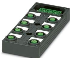
Scatola di distribuzione elemento di base, applicazione: Standard, tipo di connessione: Connettore femmina M12 Plastica, numero degli slot: 8, numero poli: 5, codifica: A, occupazione slot: doppi, segnalazione di stato: sì, PNP; connessione linea principale: Morsetto a vite estraibile, schermatura: no
