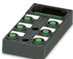
Scatola di distribuzione elemento di base, applicazione: Standard, tipo di connessione: Connettore femmina M12 Plastica, numero degli slot: 6, numero poli: 4, codifica: A, occupazione slot: singolo, segnalazione di stato: sì, PNP; connessione linea principale: Morsetto a vite estraibile, schermatura: no
