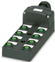
Scatola di distribuzione, applicazione: Standard, tipo di connessione: Connettore femmina M12 Plastica, numero degli slot: 8, numero poli: 5, codifica: A, occupazione slot: doppi, segnalazione di stato: no, Universale; connessione linea principale: Morsetto a vite estraibile 180°, schermatura: no
