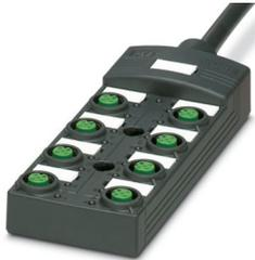
Scatola di distribuzione, applicazione: Standard, tipo di connessione: Connettore femmina M12 Plastica, numero degli slot: 8, numero poli: 4, codifica: A, occupazione slot: singolo, segnalazione di stato: sì, PNP; connessione linea principale: Attacco fisso 180°, PUR/PVC, lunghezza cavo: 10 m, schermatura: no
