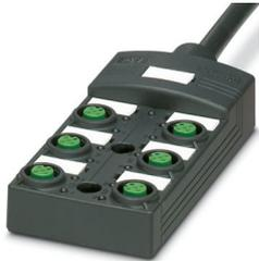
Scatola di distribuzione, applicazione: Standard, tipo di connessione: Connettore femmina M12 Plastica, numero degli slot: 6, numero poli: 4, codifica: A, occupazione slot: singolo, segnalazione di stato: no, Universale; connessione linea principale: Attacco fisso 180°, PUR/PVC, lunghezza cavo: 10 m, schermatura: no
