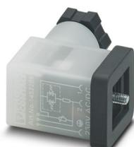
Connettore per valvole, Universale, 3-poli, Connettore per valvole CI (9,4 mm), Connessione a vite, connessione a vite per cavo M12, diametro esterno conduttore 4 mm ... 6 mm
