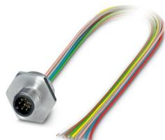
Connettore per apparecchi anteriore, 8-poli, Connettore, diritto, M12, codifica: A, su estremità conduttore libera, Montaggio anteriore, M20 x 1,5, Fili singoli, lunghezza cavo: 0,5 m, 0,25 mm<sup>2</sup>, Filo in TPE, saldato, Prodotto alternativo secondo RoHS II senza eccezione 6c (Pb < 0,1 %) cod. art.: 1239796
