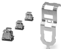
Set di accessori per collegare in modo semplice e affidabile schermature per cavi al CONTACTRON Speed Starter. Essi consistono in una lamella schermante di 45 mm, 2 morsetti di collegamento schermatura per le linee segnale e un morsetto di collegamento schermatura per il cavo motore.
