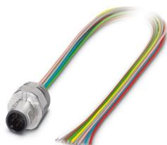
Connettore per apparecchi anteriore, 8-poli, Connettore, diritto, M12-SPEEDCON, codifica: A, su estremità conduttore libera, Montaggio anteriore, M16 x 1,5, Fili singoli, lunghezza cavo: 2 m, 0,25 mm<sup>2</sup>, Filo in TPE, saldato, Questo articolo è in continuo adattamento. Alternativa senza piombo secondo RoHS II senza eccezione 6c (Pb < 0,1%) possibile in anticipo su richiesta.
